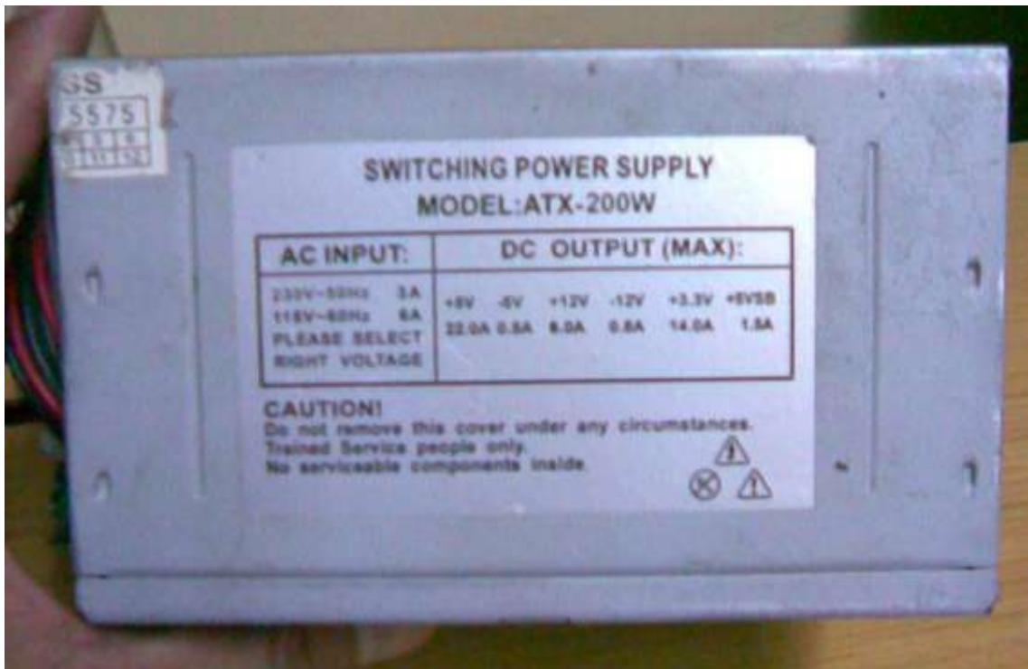
Figura 6: especificaciones de una fuente de poder ATX
