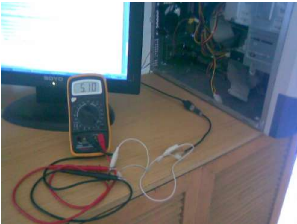
Figura 1: voltaje a la salida del USB
