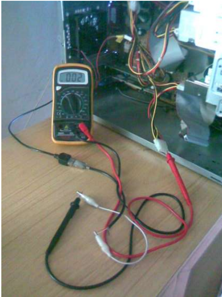
Figura 5: prueba de continuidad entre la fuente y el USB
