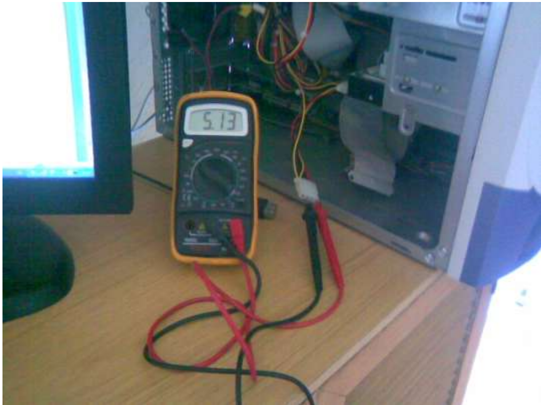
Figura 2: voltaje de salida de los conectores para CD-ROM y HDD
