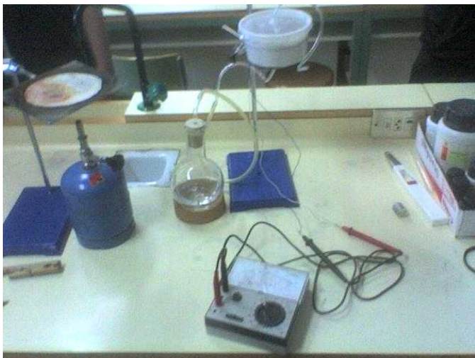
Tercera prueba, aumentando la superficie de los electrodos
