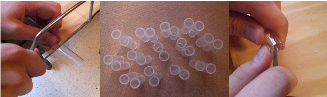
El tubo fino lo tuvimos que cortar y limar a mano
