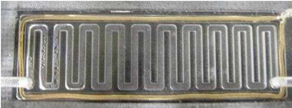
Pila de hidrógeno con membrana de intercambio de protones (PEM) Se puede apreciar la condensación del agua formada en la salida de los gases
