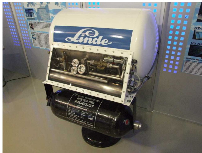
Prototipo de tanque de almacenamiento de hidrógeno líquido
