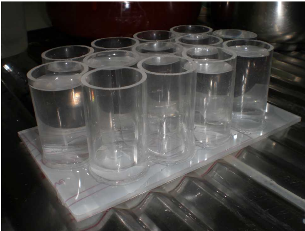
Detectamos varias fugas al llenar los tubos de agua, así que las localizamos comprobando las uniones mediante una linterna y las reparamos desde el interior de los tubos
