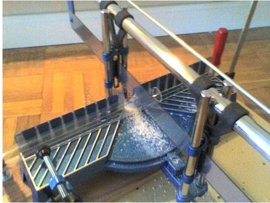
Utilizamos una sierra especial para cortes a 90°
