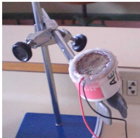
Segunda prueba, aumentando la temperatura del electrolito
